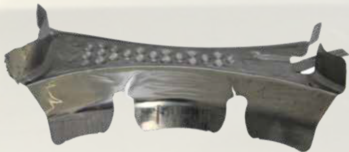
熱シールドに割れとシワが発生し シミュレーション結果を実証
