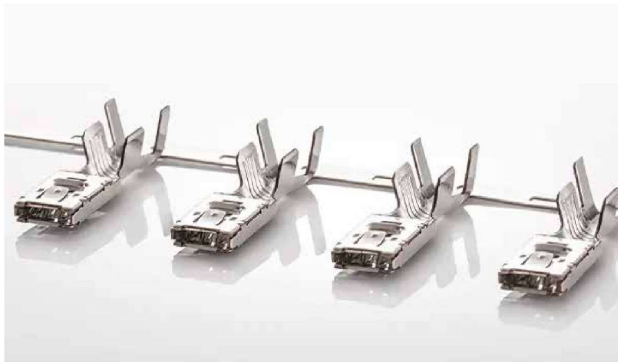
通常、板厚0.2mm~0.4mm のものが使用されます。 単一工程で製造された多極コネクタ：選択的に亜鉛メッキを施したプレス成形ストリップ
